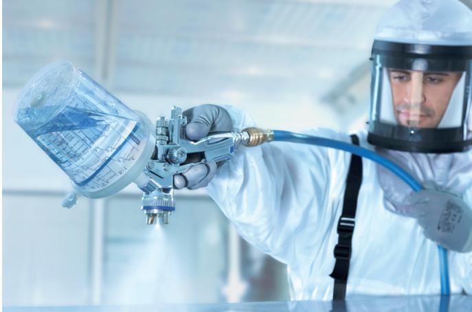
Без адаптера – бачки SATA RPS устанавливаются прямо на пистолет SATAjet 4000 B, что снижает его вес и сокращает усилия по очистке.
