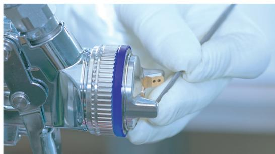
**Ручная регулировка:** Каждый сменный комплект "настраивается" вручную для достижения оптимального факела.
